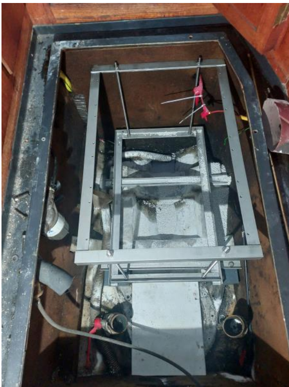
Das Gestell. Unterer Rahmen auf zwei Querträger. Oberer Rahmen mit Gewindestangen auf Abstand zum unteren eingestellt. Beide Rahmen werden am Niedergangsschott (Blickrichtung) verschraubt
